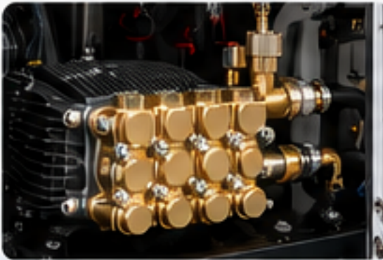
PROFESYONEL TRİPLEX POMPA Seramik pistonlu, uzun ömürlü.
